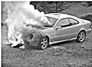
В автомобиле два основных источника огня – топливо (бензин, солярка, газ) и электричество, собственно главных причин тоже две – утечка топлива и короткое замыкание. В любом случае, если следить за техническим состоянием автомобиля, то риск возгорания можно если не исключить совсем, то существенно уменьшить.
